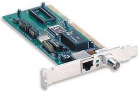
Tarjeta de red LAN con conexión híbrida (RJ-45 + BNC)
