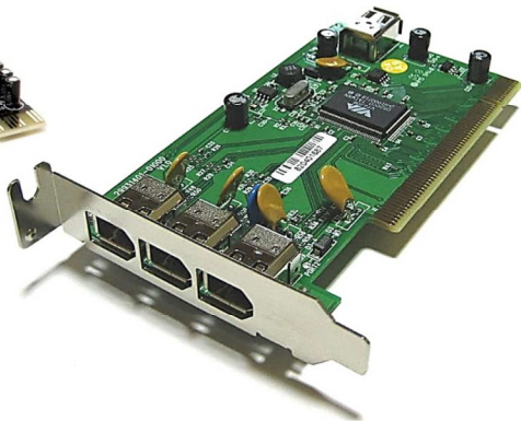
Tarjetas de ampliación puertos USB y Firewire (PCI y PCI-Express)
